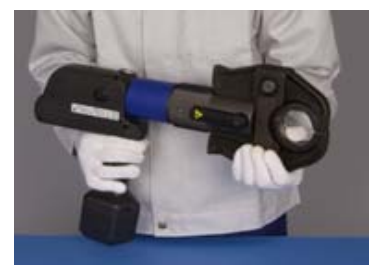
⑥充電式プレス工具を使用の場合、電動式プレス工具と同様にプレス工具に継手サイズに適合した締付ジグを取り付け固定ボルトセットする。
