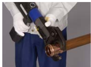
⑧接合終了後プレス工具の解放ボタン(黒色)を押し次に締付ジグを手動で開く。作業完了
