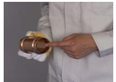
③継手内面にOリングが正しく入っていることを確認する。 油やグリースの使用禁止。
