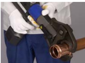
⑦締付ジグ先端を手動で開き、締付箇所直角にセットする。継手がマーキング位置まで挿入されていることを確認し、プレス工具のスタートボタン(白色)を押し接合を開始する。
