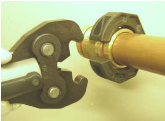
⑧プレス工具に締付治具(締付用リング専用)を取付け固定ボルトでセットし、次に締付治具先端を手動で開き、リング外側の固定箇所にセットする。
